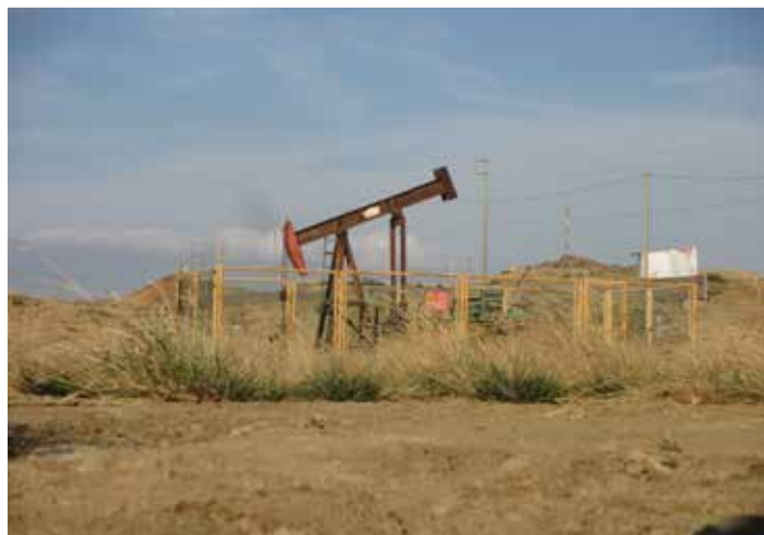
Latido mecánico del subsuelo. Las máquinas de bombeo de petróleo extraen el crudo y lo impulsan por tuberías hasta los tanques de almacenamiento. © Archivo Coast 2 Coast Movement (2017)
